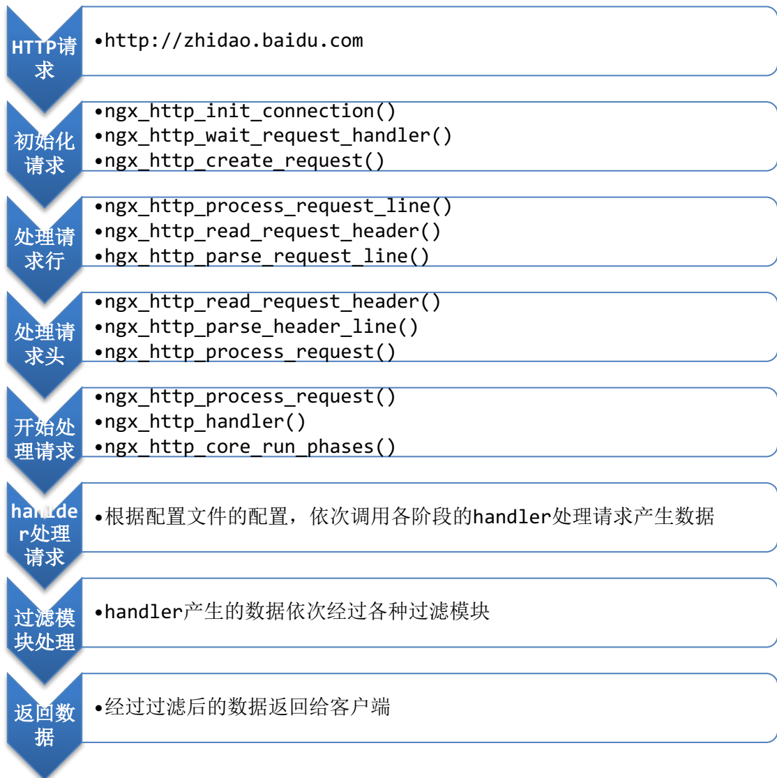
图 2-2 nginx 对 http 的请求处理流程
